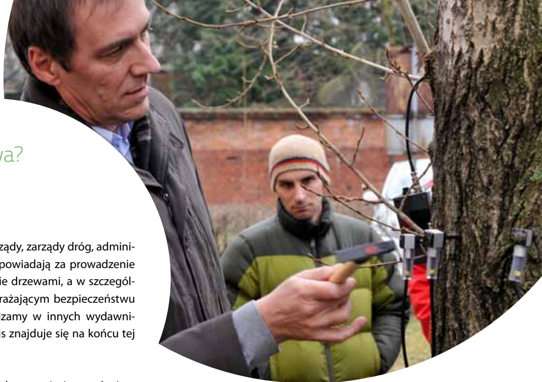
Badanie wnętrza drzewa za pomocą tomografu dźwiękowego.
