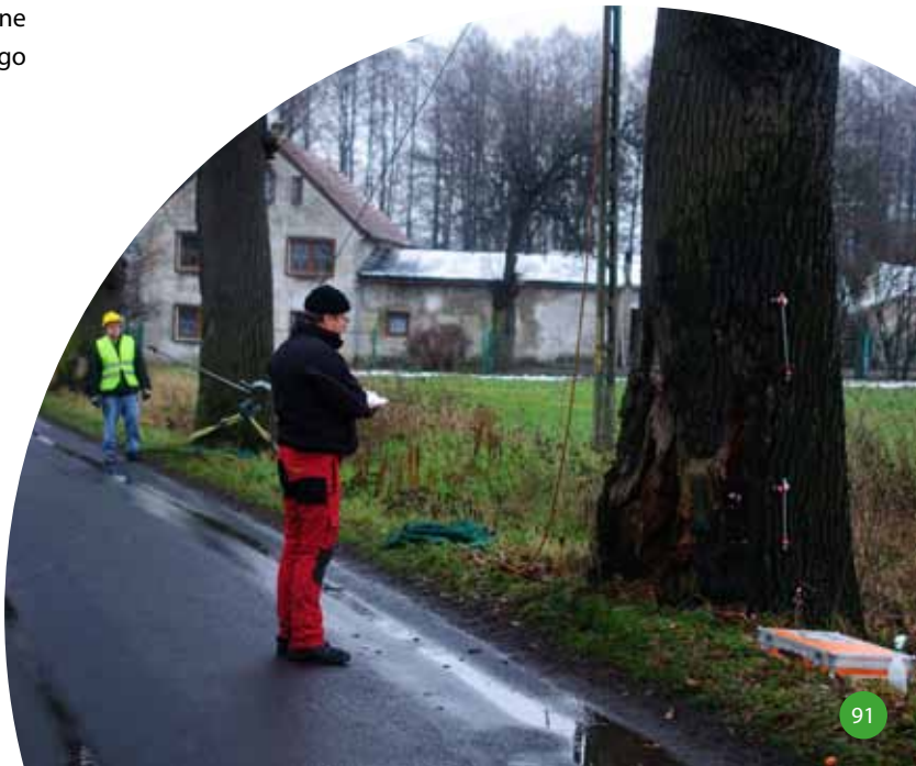
Badanie wnętrza drzewa za pomocą tomografu dźwiękowego.
